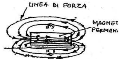
Le proprietà, che abbiamo visto prima, dimostrano che lo spazio che circonda un magnete acquista caratteristiche dovute all'introduzione dello stesso magnete nello spazio, cioè come abbiamo visto in elettrostatica possiamo dire che un magnete crea un **campo magnetico** il cui simbolo è **H**.
