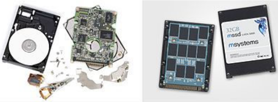
Un comune disco rigido (a sinistra) confrontato con un'unità a stato solido (a destra)
